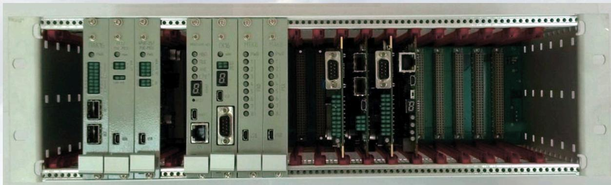
К особенностям модуля можно отнести возможность преобразования до четырех первичных цифровых потоков Е1 и поддержку протокола IEEE 1588, с помощью которого восстанавливается информация о синхронизации потоков Е1 с задающими генераторами телефонной сети общего пользования.
